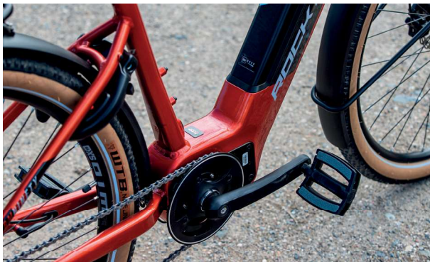
Díky uložení motoru je dost prostoru snadný výstup z kola. Další ochranou proti nedobrovolné změně majitele jsou integrované čelisti.
