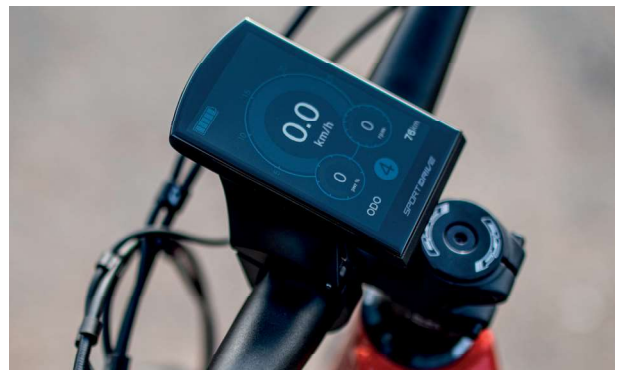
Přehledný displej Sport Drive může nejen dobíjet přes USB port, ale také zajistit kolo proti odcizení.
