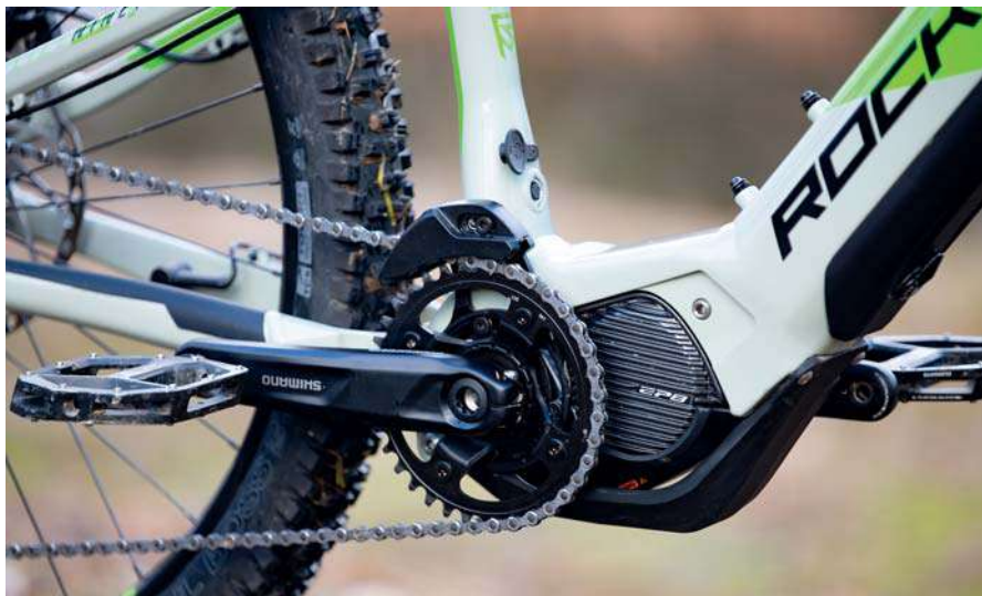
Motor Shimano EP8 a nad ním odhalený konektor pro nabíjení.
