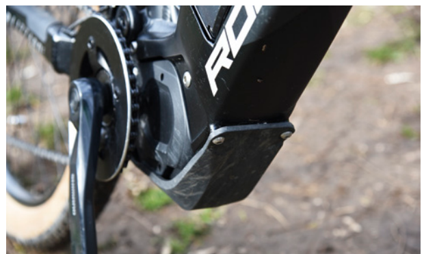
Plastový kryt motoru zespoda rámu jej chrání před tvrdými nárazy, odlétávajícími kameny i první dávkou bahna a vody
