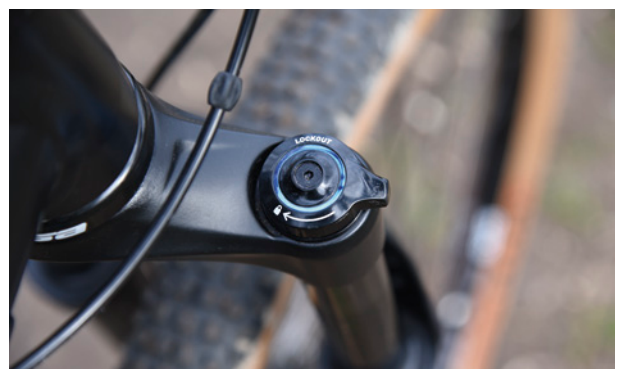
Lockout, neboli zamykání a odemykání vzduchové odpružené vidlice RockShox Judy Silver TK je umístěn na pravé straně korunky vidlice
