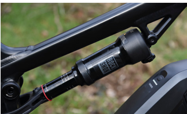
Tlumič RockShox Deluxe Select R pracuje se zadní stavbou ve zdvíhu 130 mm a pracuje na jedničku
