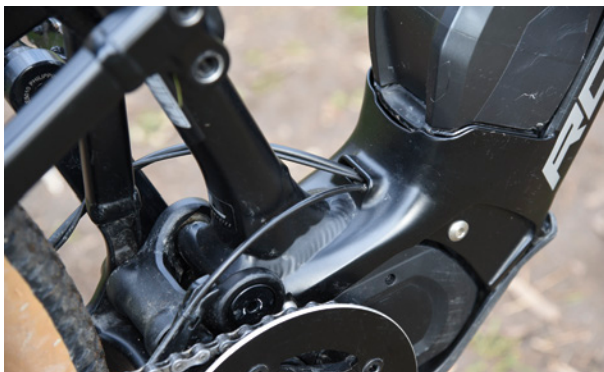
Některé detaily prozrazují levnější cestu. Baterie je usazená v jakémsi rámovém pouzdře, ale není integrovaná. Komu by to však vadilo.
